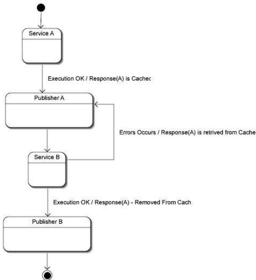
1. Il servizio A viene eseguito con successo e produce la risposta Response(A). La risposta di A viene mantenuta in cache.
