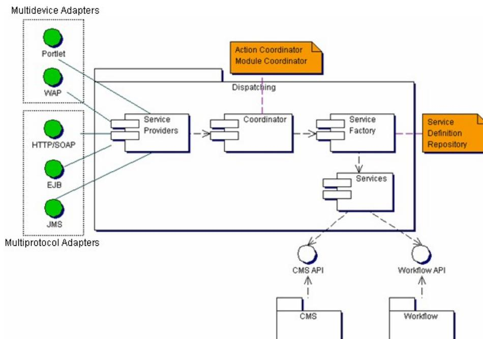
L'aggiunta di nuovi adapter è possibile tramite un meccanismo di plug-in.
