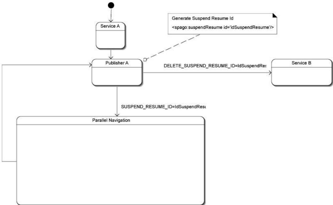
Per far fronte a situazioni di questo tipo in Spago viene fornito l'automatismo di **Suspend/Resume**. Questo automatismo non può essere implementato in modo completamente automatico in Spago, per ottenere una "situazione istantanea" prima di iniziare una navigazione parallela è necessario, se ci si trova ad esempio nel publisher A:
