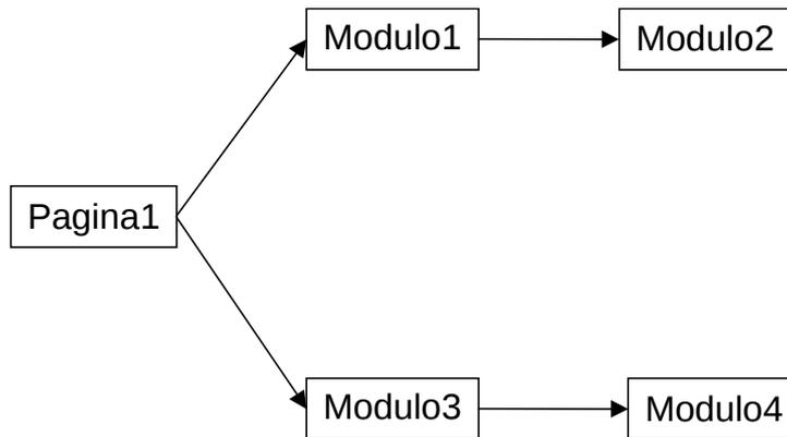
Supponiamo di aver definito un grafo come in figura: il punto di inizio valutazione del grafo è la pagina. L'attività di valutazione del grafo è ricorsiva, e la navigazione del grafo è in profondità: questo significa che i moduli vengono invocati nel seguente ordine: Modulo1, Modulo2, Modulo3, Modulo4.
